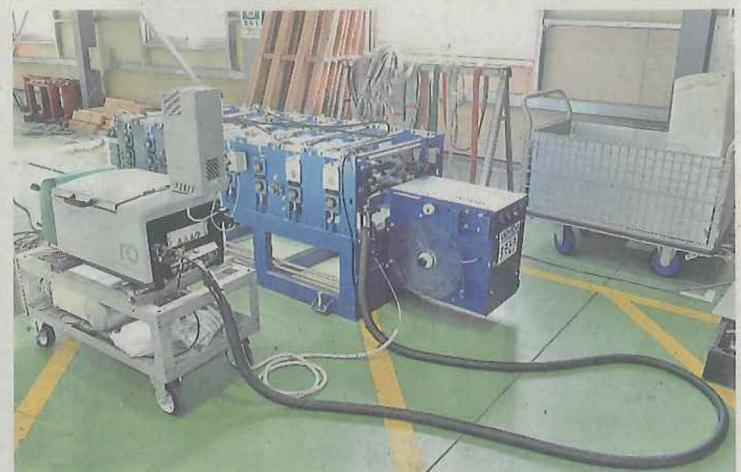
防水性能をさらに高めるため、金属板にホットメルトを塗布する装置（左側）
