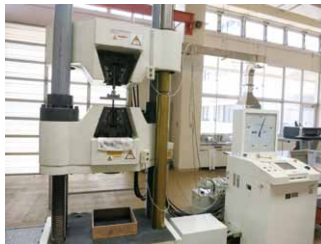
香川県産業技術センターにて 新型インサート引張試験の実施
