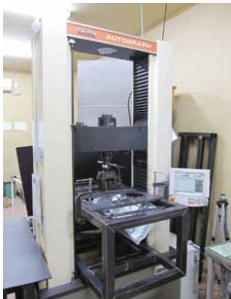
Z500 クローザールーフ吊子引張試験の実施
