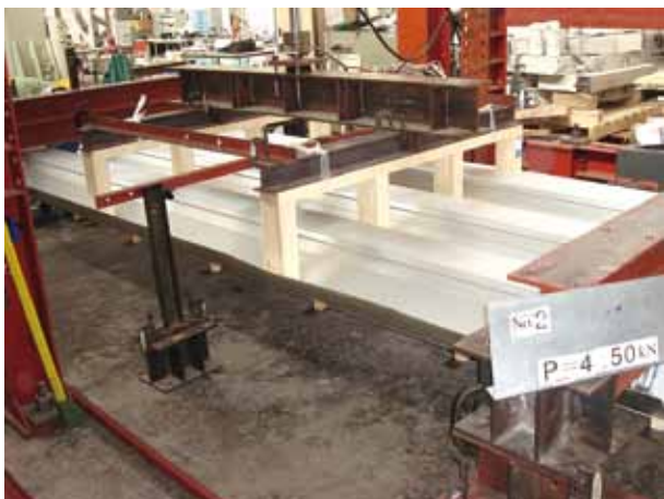
Z500 クローザールーフ (負圧) 曲げ耐力試験
