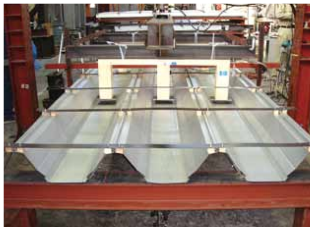
Z500 クローザールーフ (正圧) 曲げ耐力試験
