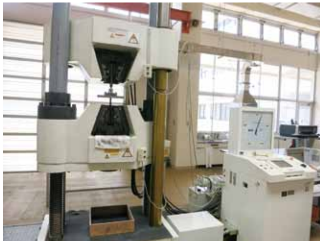
香川県産業技術センターにて 新型インサート引張試験の実施
