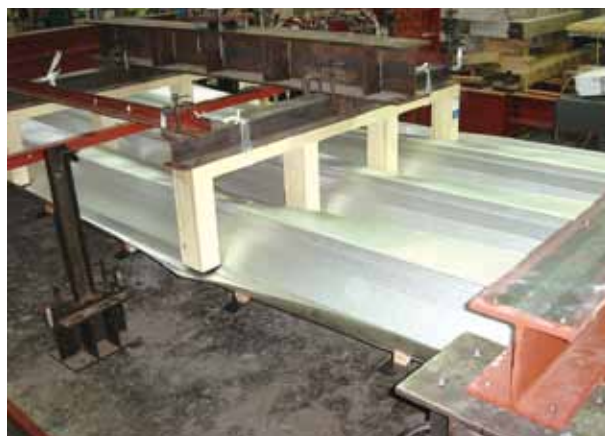
Z500 クローザールーフ損傷状況
