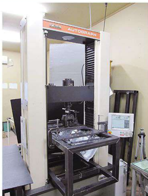
Z500 クローザールーフ吊子引張試験の実施
