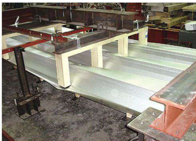
Z500 クローザールーフ損傷状況
